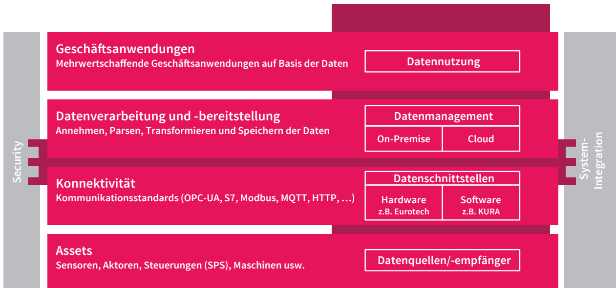
Das Schichtenmodell veranschaulicht die Logik der IoT-Welt: Daten der Assets für Geschäftsanwendungen bereitstellen
